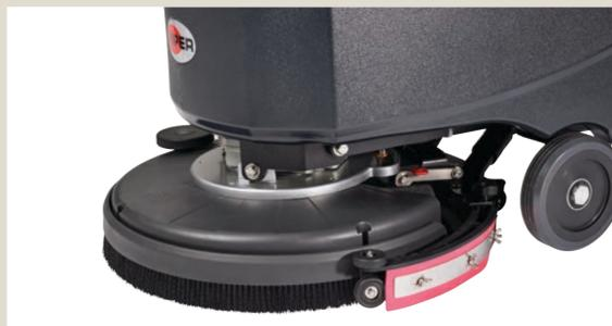
Legen Sie die Bürste oder den Padhalter unter das Deck und senken Sie das Deck oder den Bürsten-/Padhalter durch Drücken des Pedals ab.
