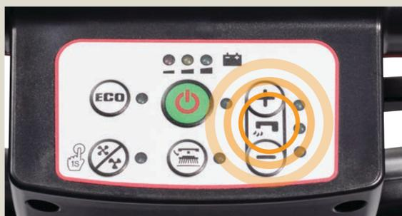
Drücken Sie die Taste + oder -, um den Durchfluss der Reinigungslösung zu erhöhen oder zu verringern.
