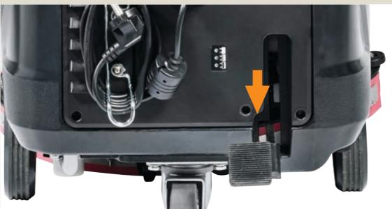
Heben Sie das Deck durch Drücken des Pedals an.
