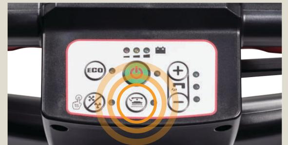
**Täglich:** Drücken Sie bei eingeschalteter Maschine und angehobenem Deck die Abwurf-Taste, um den Bürsten-/Padhalter freizugeben, und reinigen und überprüfen Sie ihn auf Beschädigung/Abnutzung.
