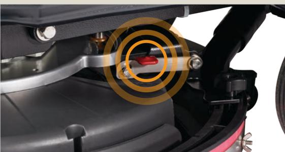
Für doppeltes Scheuern: Heben Sie die Saugleiste von Hand an, bis sie einrastet, und schalten Sie die Absaugung aus. Um zum Arbeitsmodus zurückzukehren, geben Sie die Saugleiste mit dem roten Hebel frei und schalten Sie die Absaugung wieder ein.
