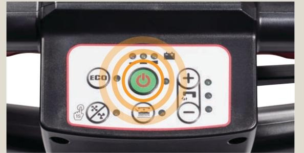
Schalten Sie die Maschine ein und vergewissern Sie sich, dass die Batterieleistung ausreicht, um die Arbeitsaufgabe durchzuführen. Laden Sie die Batterien bei Bedarf auf.
