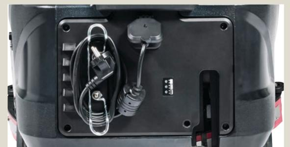
**Täglich** Batterien aufladen: Das Ladekabel mit einer Steckdose verbinden. Die Leuchte leuchtet rot während des Aufladens und grün, wenn der Ladevorgang abgeschlossen ist.
