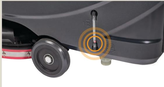
Überprüfen Sie den Stand der Reinigungslösung anhand der Anzeige mit der roten Kugel auf der linken Seite der Maschine.
