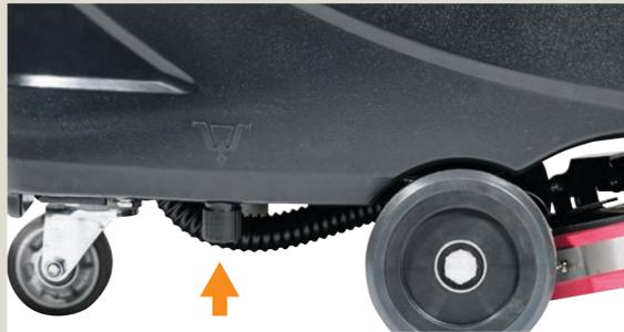
**Täglich:** Entleeren Sie den Frischwassertank mit dem Ablassventil des Tanks unter der Maschine.
