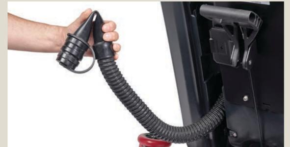
**Täglich:** Entleeren Sie den Schmutzwassertank mit dem dafür vorgesehenen Schlauch. Knicken Sie den weichen Teil des Schlauchs vor dem Entfernen der Kappe, um den Durchfluss zu steuern.
