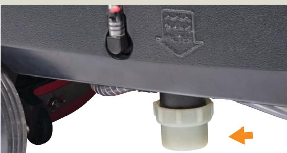
**Wöchentlich:** Überprüfen Sie den Lösungsfilter und reinigen Sie ihn gegebenenfalls.
